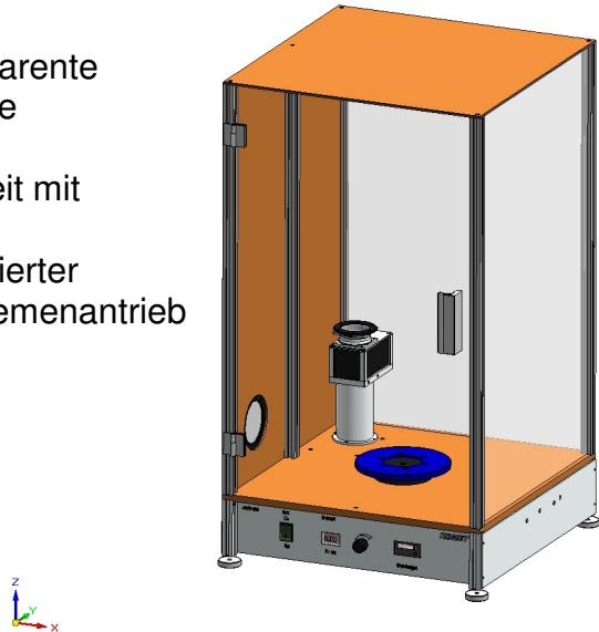
Der Teststand ist mit einem Umdrehungszähler ausgerüstet und mit Befestigungsmöglichkeiten zum Einbau der Netzversorgung und Motoransteuerung. Der Teststand ist in der Klimakammer von -20 °C bis +100 °C einsetzbar. Als Gegenhalter ist eine zusätzliche Profilschiene eingebaut.
